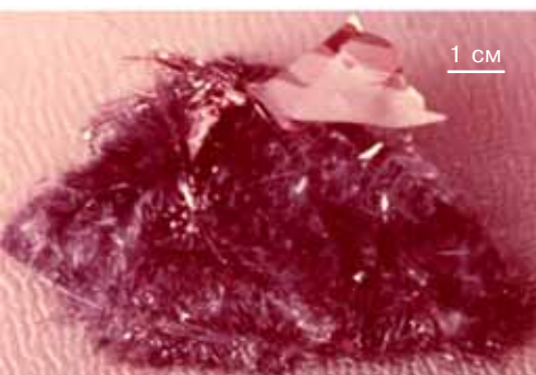
4 Типичный результат химического переноса: нитевидные кристаллы моноарсенида кремния (SiAs) густо покрывают кремниевую подложку. Небольшая часть вещества кристаллизуется в виде тонких пластинчатых кристаллов
